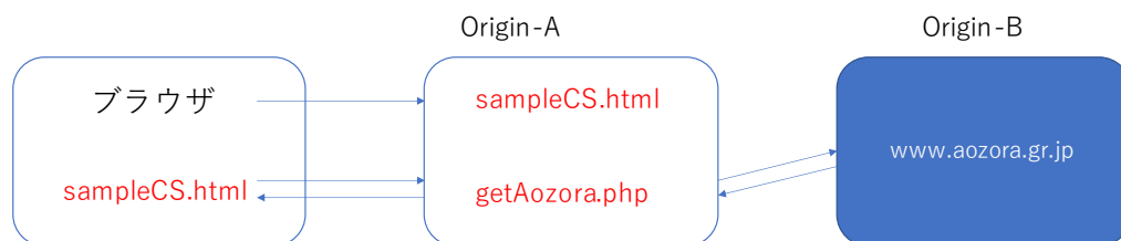
図 3 CORS エラーを回避する仕組み
